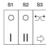
L'interruttore S3 attiva la funzione "Free cooling" (Bypass), interrompendo il flusso alternato in modo che l'unità operi in modalità "solo estrazione" o "solo immissione", per evitare lo scambio di calore quando non richiesto. Per definire la modalità "solo estrazione" o "solo immissione", posizionare opportunamente i jumper integrati (fig. 20A-20B). Il LED posto sul frontale indica che la modalità Free Cooling è attiva.
