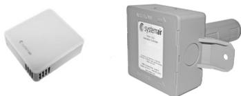
Les sondes de qualité d'air intérieur (QAI) sont des transmetteurs de CO<sub>2</sub>, d'humidité relative et de température qui doivent être installés dans une gaine d'extraction ou dans la pièce en fonction du type de transmetteur.
