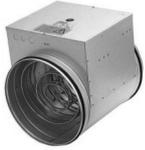
Il est possible d'installer un préchauffage électrique dans la gaine d'air neuf afin de préchauffer l'air avant qu'il atteigne l'appareil et d'éviter la formation de givre dans l'échangeur de chaleur.
