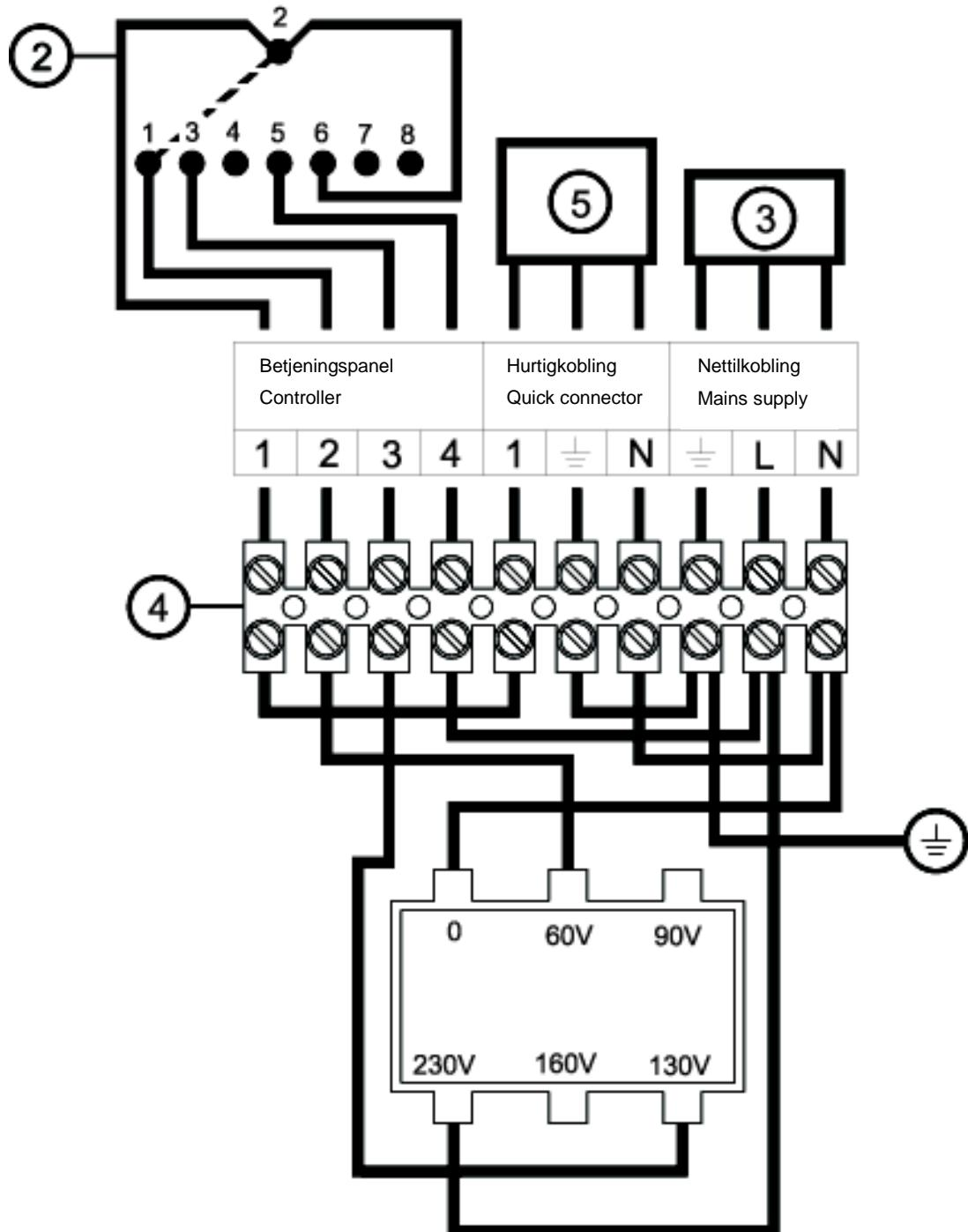
**N** Koblingsskjema betjeningspanel, type CT/2
