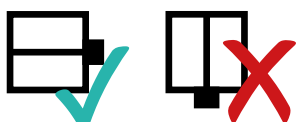
Fig. 37: El60-montage van een rechthoekige brandklep op een wand en uit een wand
