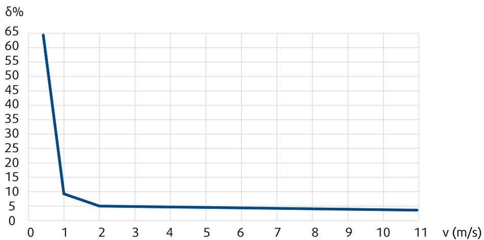
Écart de réglage absolu max. typique  $\delta$  par rapport au débit d'air réel en fonction de la vitesse d'écoulement d'air  $v$  dans le conduit
