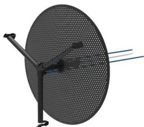
Zeus est un amortisseur de contrôle du PB-VVK-R...plénum D2. Il contient des tubes d'impulsion pour mesurer la pression différentielle à l'aide d'un dispositif de mesure portable. Il peut être ajusté manuellement à l'aide d'un engrenage à câble.
