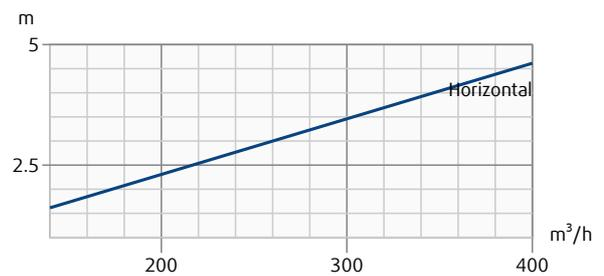
Druckverlust und Geräuschpegel abhängig vom Luftvolumenstrom, gemessen mit THOR-E Anschlusskasten. Wurfweite mit Endgeschwindigkeit 0,2 m/s in Abhängigkeit vom Luftvolumenstrom.
