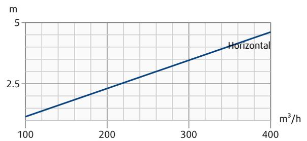
Druckverlust und Geräuschpegel abhängig vom Luftvolumenstrom, gemessen mit THOR Anschlusskasten.
