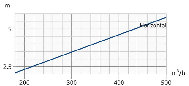
Druckverlust und Geräuschpegel abhängig vom Luftvolumenstrom, gemessen mit THOR-F Anschlusskasten. Wurfweite mit Endgeschwindigkeit 0,2 m/s in Abhängigkeit vom Luftvolumenstrom.
