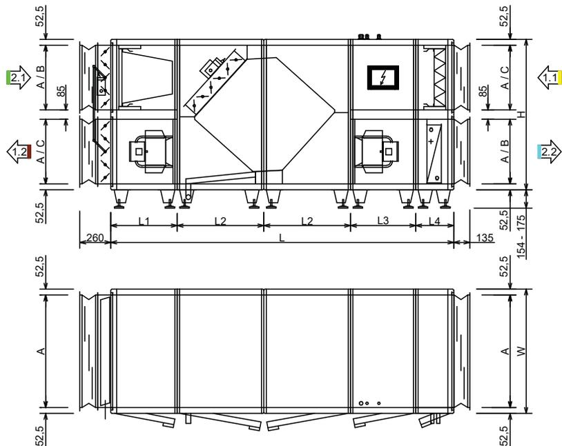
2.1 – Außenluft    1.1 – Abluft    2.2 – Zuluft    1.2 – Abluft
