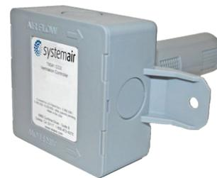
Kanaltransmitter zum Messen der Kohlendioxidkonzentration in der Luft. Messbereich 0...2000 ppm und Ausgangssignal 0...10 V DC
