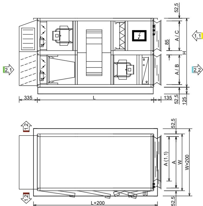
2.1 - Außenluft    1.1 - Abluft    2.2 - Zuluft    1.2 - Abluft
