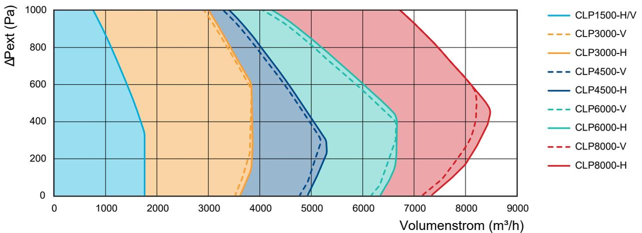
Das Diagramm zeigt die maximale Fließkurve. Der Bereich ohne Kurve ist kein anwendbarer Bereich.
