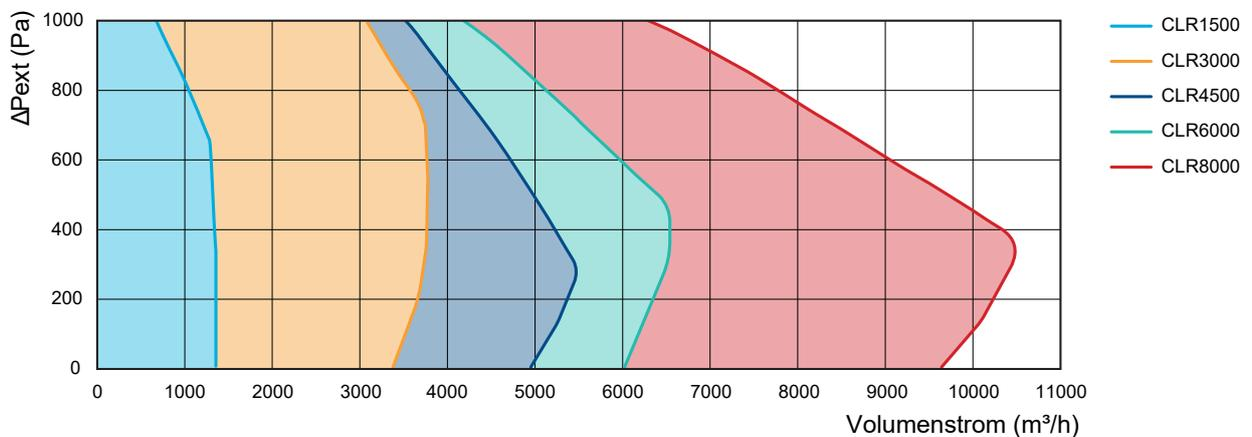
Das Diagramm zeigt die maximale Fließkurve. Der Bereich ohne Kurve ist kein anwendbarer Bereich.
