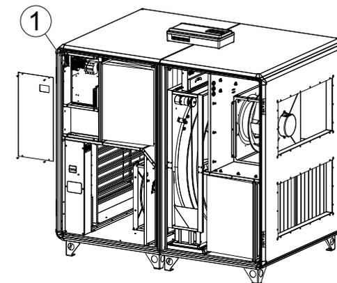
Retirez les passe-câbles du toit de la centrale de traitement d'air. De nouveaux passe-câbles sont fixés aux câbles du kit d'extension.
