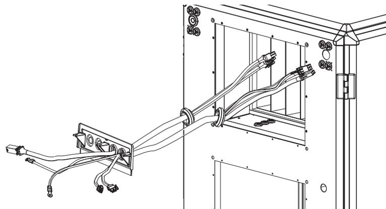
Connectez les 4 connecteurs de câblage de la centrale de traitement d'air aux connecteurs de câblage correspondants du kit d'extension. Fixez le câble PE. L'emplacement dans la centrale de traitement d'air est marqué par le symbole de la protection de terre. L'emplacement diffère selon le type de centrale de traitement d'air, voir les images.
