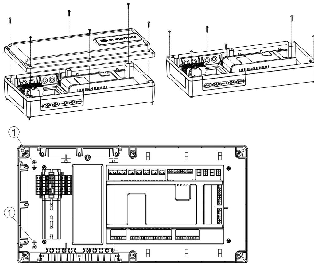
Raccordez le kit d'extension du coffret de régulation dans la centrale de traitement d'air.
