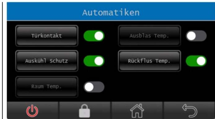
Die Automaten können mit dem jeweiligen Schiebeschalter aktiviert/deaktiviert werden. Je nach Automatik sind die definierten Parameter wie Temperatur oder Lüfter- und Heizwert einstellbar.
