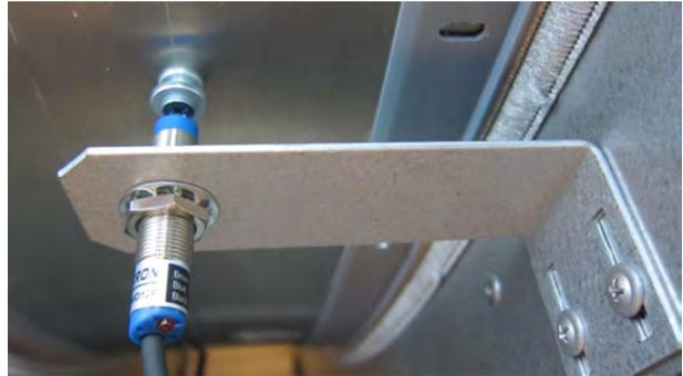
Montar el tornillo que vemos en la imagen sobre el rotor para activar la señal desde el sensor.
