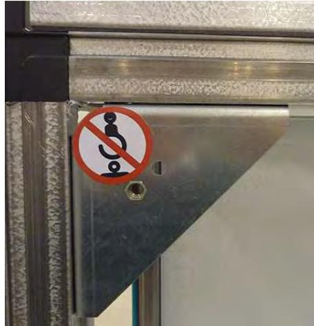
Este soporte de las unidades Geniox tamaños 10 a 18 no sirve para izar la sección. Este soporte sirve para mantener dos secciones permanentemente unidas con pernos de 8 mm.
