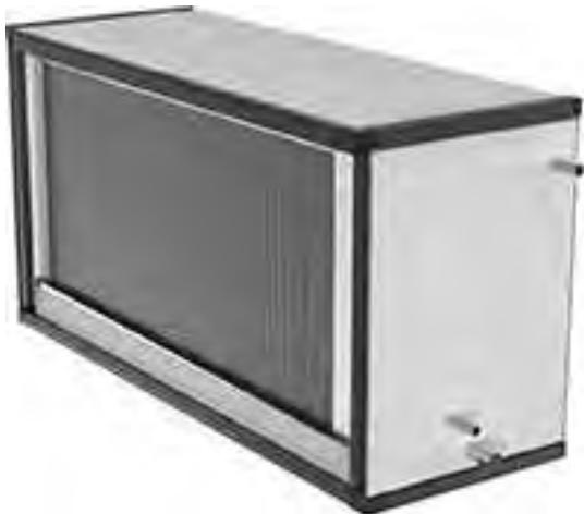
Una vez al año es necesario limpiar la bandeja de condensados que está debajo de la batería de frío, así como el drenaje y el sifón. Debe vigilar que haya agua suficiente en el sifón. Si se ha instalado un separador de gotas en la batería de frío, hay que comprobarlo una vez al año y limpiarlo si es necesario.
