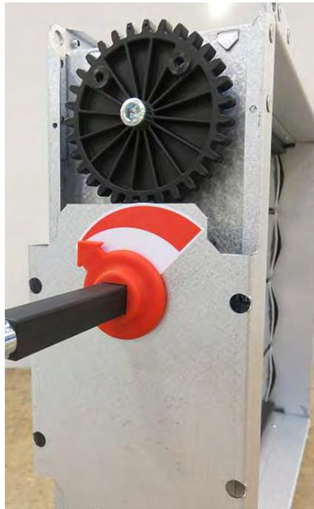
Las hojas de las compuertas van equipadas con cojinetes sintéticos que no requieren lubricación. Cuando el motor de la compuerta está en posición de cerrada, la estanqueidad de la compuerta debe ser comprobada visualmente una vez al año. El motor de la compuerta debe ajustarse si la compuerta no cierra herméticamente.
