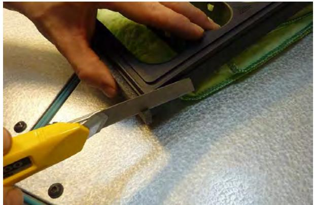
Empuje con cuidado los filtros por el perfil en U, asegurándose de que no haya fugas entre los filtros. Compruebe que el lado vertical del último filtro del perfil en U quede totalmente uniforme con el extremo del perfil en U. Si el extremo del último filtro no está totalmente uniforme con el extremo del perfil en U, hay que añadir un perfil autoadhesivo adicional, para evitar que queden brechas entre el perfil de goma de la puerta de inspección y el último filtro.
