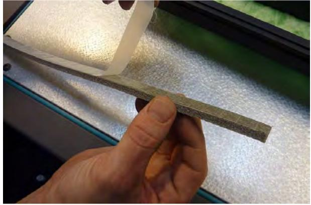
Coloque la tira autoadhesiva sobre **un** lado vertical del bastidor del filtro
