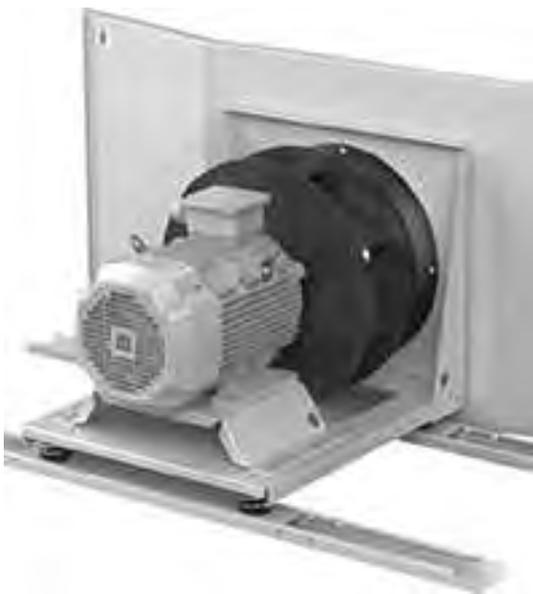
El polvo se puede acumular en el rodete del ventilador, cosa que puede provocar un desequilibrio y vibraciones. Por lo tanto, el rodete del ventilador debe comprobarse y limpiarse una vez al año si es necesario. Las monturas anti vibraciones y las conexiones flexibles deben comprobarse al mismo tiempo. Si las monturas anti vibraciones presentan algún tipo de daño, habrá que cambiarlas.
