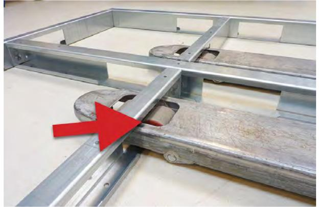
Las horquillas de la carretilla elevadora deben ser más largas que el ancho o el largo de la sección/unidad para poder transportarla con seguridad.
