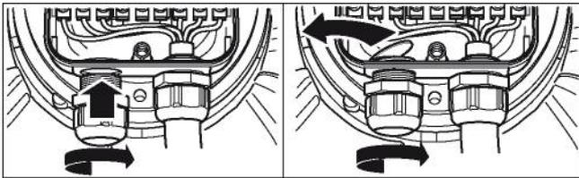
Abb. 4: Durchbruch Kabelverschraubung
