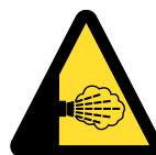
DECHARGES DE SOUPAPES DE SURETE
