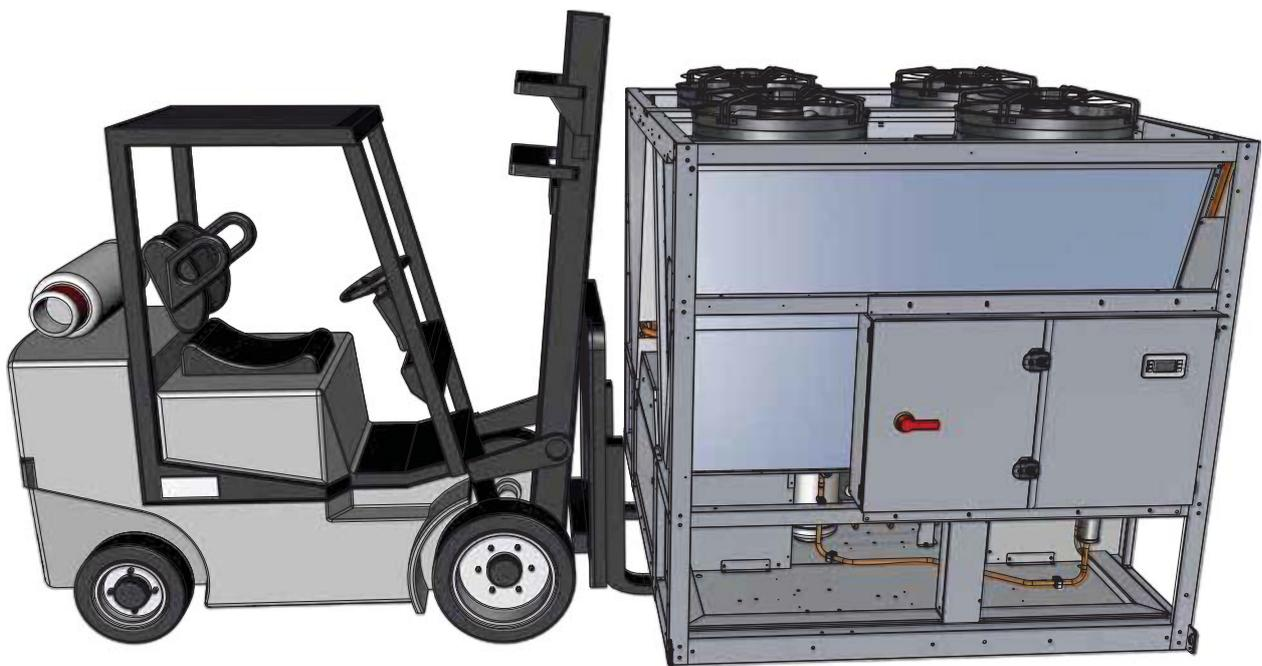
Zwischen den Sockel des Gerätes und den Hubwagen einen Sicherheitskeil schieben, damit Struktur und Blechgehäuse des Gerätes nicht beschädigt werden.
