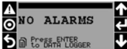
Appuyer sur la touche ALARM pendant 3 secondes pour réinitialiser l'alarme, si la cause qui a généré l'alarme est résolue.
