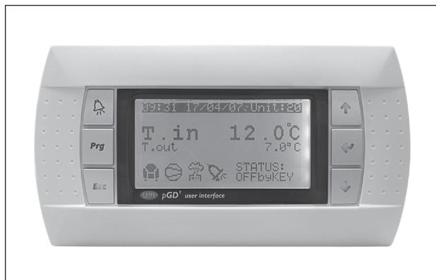
L'afficheur utilisé est du type à cristaux liquides 8 lignes x 22 colonnes. Les grandeurs et les informations relatives au fonctionnement alternent sous forme de masques sur l'écran.
