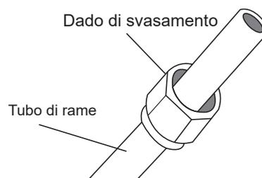
4. Rimuovere il nastro PVC dalle estremità del tubo quando è pronto per eseguire il lavoro di svasamento.
