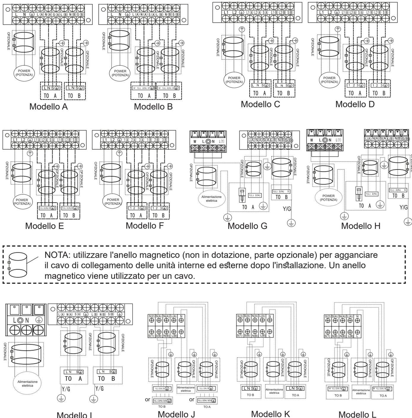
**NOTA:** utilizzare l'anello magnetico (non in dotazione, parte opzionale) per agganciare il cavo di collegamento delle unità interne ed esterne dopo l'installazione. Un anello magnetico viene utilizzato per un cavo.
