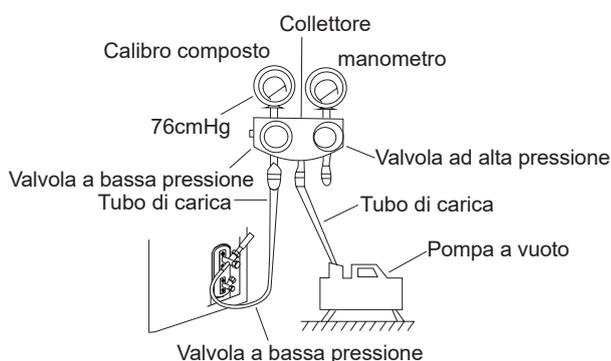
1. Collegare il tubo flessibile di carica del manometro del collettore alla porta di servizio sulla valvola a bassa pressione dell'unità esterna.
