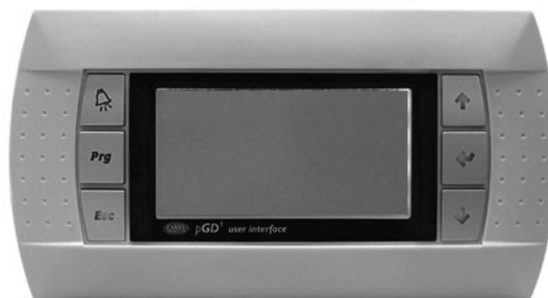
L'afficheur utilisé est du type à cristaux liquides 8 lignes x 22 colonnes. Les grandeurs et les informations relatives au fonctionnement alternent sous forme de masques sur l'écran. On peut se déplacer à l'intérieur des masques en appuyant sur les touches du terminal, comme décrit ci-dessus:
