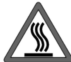
**Avertissement zones à haute température A côté des conduites ou des composants chauds**
