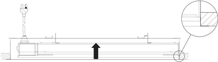
9. Bewegen Sie das Heizgerät nach links und lassen Sie es dann einrasten. Achten Sie dabei darauf, dass die Halter richtig auf dem Aufhänger aufliegen. Schütteln Sie das Heizgerät sanft, um sicherzustellen, dass es festmontiert ist.
