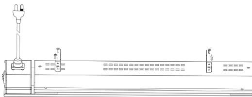
6. Befestigen Sie das Gehäuse mithilfe von 30 mm langen ST5-Schrauben an der Decke.
