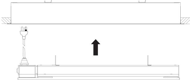
8. Setzen Sie das Heizgerät in das Gehäuse, und stellen Sie dabei sicher, dass Sie die Halterungen gemäß der Abbildung unten durch die Bohrungen an der Oberseite des Gehäuses führen:
