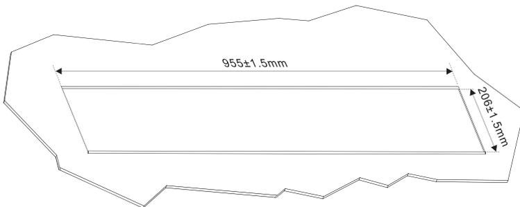
3. Bauen Sie einen Leistenrahmen gemäß der in der Abbildung unten angegebenen Maße:
