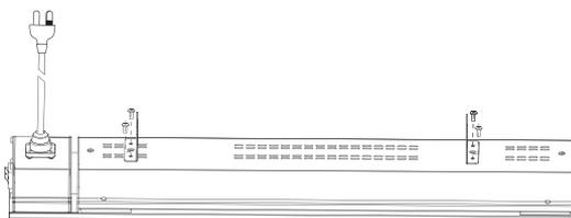
6. Fije la caja al techo y fíjelo con 4 piezas de tornillos ST5\*30mm.
