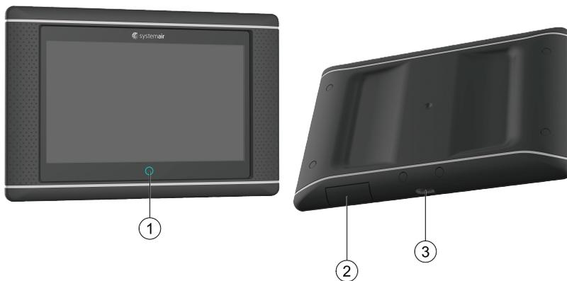
Fig. 1 (1) Botón de NaviPad, (2) conexión USB, botón de reinicio, (3) fuente de alimentación y comunicación
