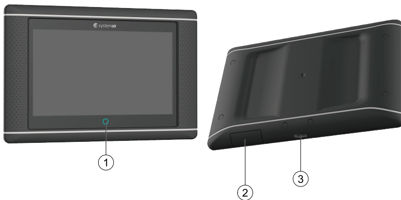
Fig. 1 (1) NaviPad-knop, (2) USB-verbinding, herstartknop, (3) voeding en communicatie
