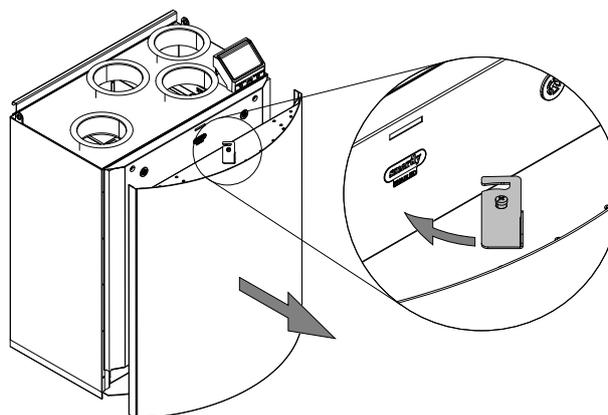
Bild 5 Äußere Frontabdeckung entfernen / befestigen
