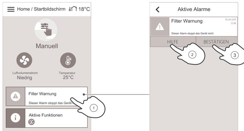
Berühren Sie die **HILFE** Taste, um mehr über den Alarm zu erfahren. Um den Alarm zu löschen, berühren Sie die **BESTÄTIGEN** Taste.
