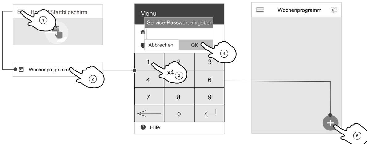
Tippen Sie auf das Symbol in der unteren linken Ecke des Bildschirms, um einen neuen Zeitplan hinzuzufügen, oder drücken Sie die Bearbeiten-Taste, um den bereits hinzugefügten Zeitplan zu ändern.
