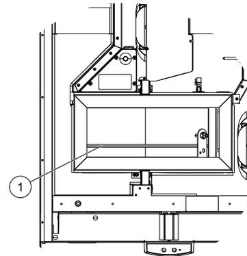
Bild 9 Rotor-Antriebsriemen
