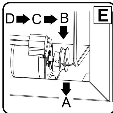
Falls beide verschweißten Riemen reißen, kann ein Verbindungsrippel als vorläufige Lösung zur Schnellreparatur dienen, bis der verschweißte Riemen durch einen neuen Riemen ersetzt werden kann. Abhängig von der Art der Installation des Gerätes ist es nicht unbedingt nötig, den Wärmetauscher zu entfernen, um eine vorläufige Reparatur des defekten Antriebsriemens vorzunehmen, sofern Zugang zur Riemenscheibe besteht.
