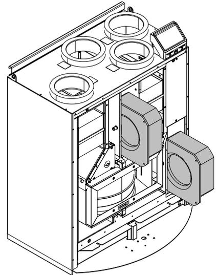
Bild 8 Abluft- und Zuluftventilatoren
