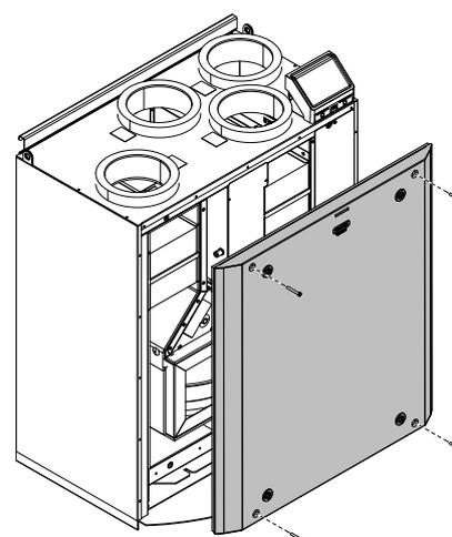
Bild 6 Innere Abdeckung entfernen / befestigen
