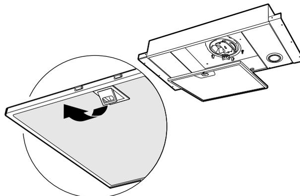
Bild 4 Entfernung des Filters der Dunstabzugshaube
