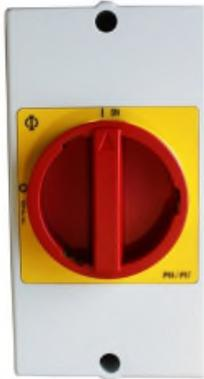
Revisionschalter in Kunststoffgehäuse mit hoher mechanischer Festigkeit, hoher UV-Beständigkeit, großen Anschlussräumen und mit rotem Schaltknopf. In Stellung "Aus" mit Vorhängeschloss abschließbar.
