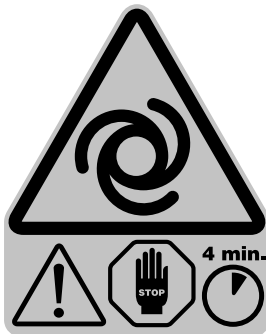
Fig. 2 Ventilateur tournant pendant une période de décélération de 4 minutes
