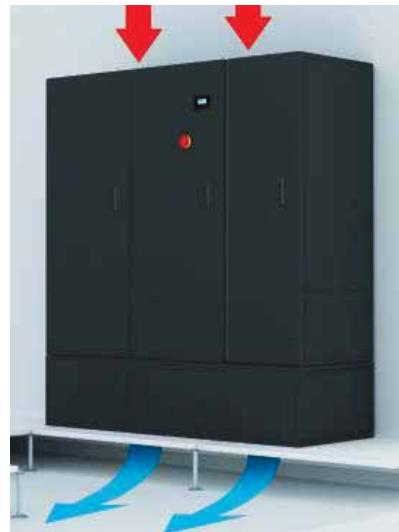
Стандартная модель для монтажа по периметру центра обработки данных при высоте свободного пространства под фальшполом менее 550 мм. В данном случае основание с фиксированной высотой 550 мм и боковыми панелями устанавливается над полом. При этом следует убедиться, что между кондиционером и потолком достаточно свободного пространства для надлежащего забора воздуха.
