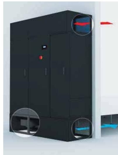
Модель для монтажа за пределами центра обработки данных в помещении без фальшпола и приточного воздуховода с обратной стороны. В данном случае основание с фиксированной высотой 550 мм оснащается боковыми панелями и задними воздухораспределительными решетками. По желанию, при отсутствии системы воздуховодов, можно установить воздухораспределительную камеру с задней воздухозаборной системой.
