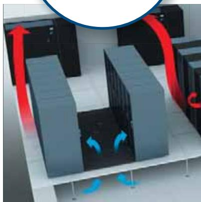
Центры обработки данных с малой плотностью размещения оборудования обычно организуются по принципу горячих и холодных коридоров.
