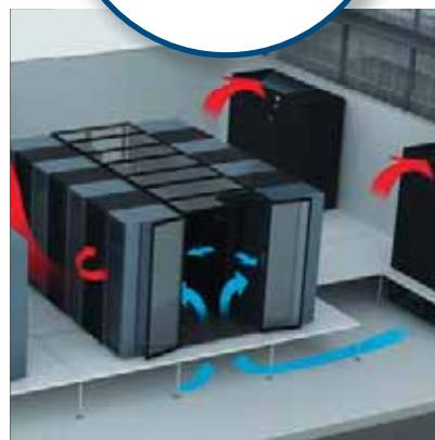
Центры со средней плотностью размещения оборудования как правило тоже организуются по принципу горячих и холодных коридоров, только еще устанавливаются дополнительные кондиционеры "в один ряд" с оборудованием.
