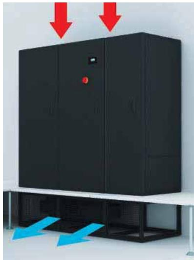
Стандартная модель для монтажа по периметру центра обработки данных. Высота свободного пространства под фальшполом должна составлять как минимум 550 мм.
